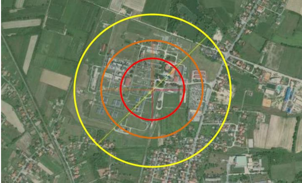
Grafički prikaz 6 Zone ugroženosti uslijed zapaljenja para propana na auto punilištu
