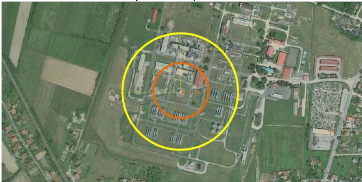
Grafički prikaz 3 Zone ugroženosti uslijed eksplozije para prirodnog benzina u pogonu -Objekti frakcionacije Ivanić Grad
