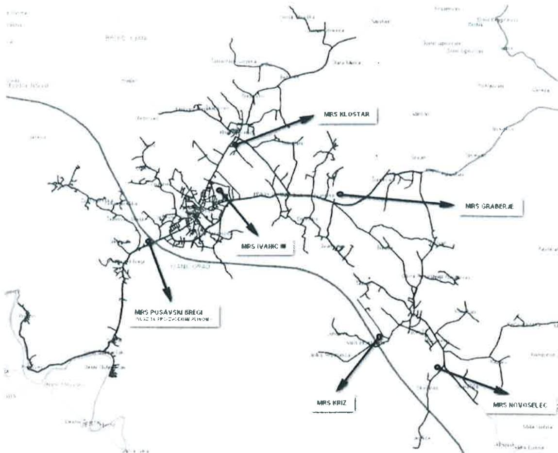
DS obuhvaća plinovode, regulacijske stanice, mjerno-regulacijske stanice, odorizacijske stanice, sustav katodne zaštite, sustav za daljinski nadzor, upravljanje i prikupljanje podataka, priklučke, plinomjere i drugu mjernu opremu, kao i svu drugu opremu i građevine ugrađene u distribucijski sustav u svrhu osiguranja sigurnog i pouzdanog pogona distribucijskog sustava i isporuke plina.
